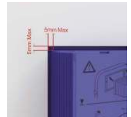
4 Теперь можно сооружать стену и делать чистовую отделку/класть плитку вокруг инсталляции. Используйте инструкцию в упаковке для того, чтобы правильно сделать отверстия. Оставьте зазор (макс. 5 мм) по периметру короба сервисного окошка.
